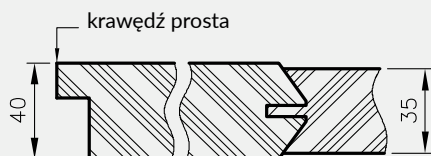
Przekrój poziomy drzwi Tizano, Tixa
