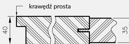
Przekrój poziomy drzwi Ena, Verano, Emena i Triesta (przekrój na wysokości ramiaka przy dużej szybie)
